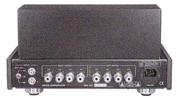
[写真15] TRX-P6Lのリアパネル。左から順に入力アッテネーター/入力端子/RとLのスピーカー端子群(4/8/16Ω)。対応真空管は6L6/KT88/EL34の3品種
