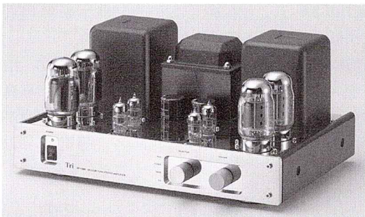
[写真13] KT88プッシュプル40W + 40WプリメインアンプVP-120S. VP-110Sの出力管をEL34からKT88に置き換えた姉妹機だ
