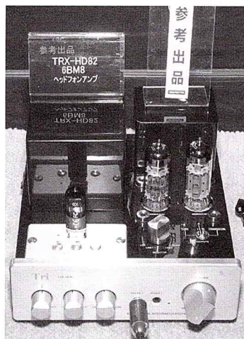
【写真7】 2011年に発売されたTRX-84HDの後継ヘッドフォンアンプTRX-HD82 (発売時税別価格95,000円)。USBメモリーに対応したUSB DAC付き、真空管と半導体の2系統出力を装備
