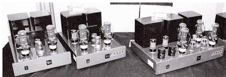
[写真1] 1998年真空管オーディオ・フェアに出品されたVPXシリーズ300Bパラシングルアンプ。左2台が20WモノラルのVPX-300MN（発売時価格ペア308,000円）、右が20W + 20WステレオアンプVPX-300PS（258,000円）
