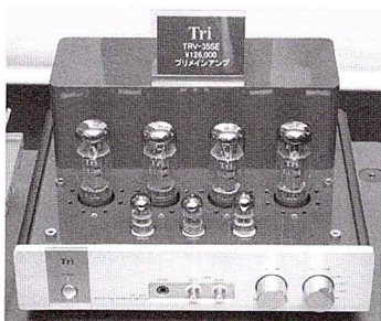
【写真7】 TRV-34SEをマイナーチェンジした同仕様の量産モデルTRV-35SE。2005年の発売で価格が12万円になり, プリアンプ専用入力とボリュームバイパススイッチが装備された
