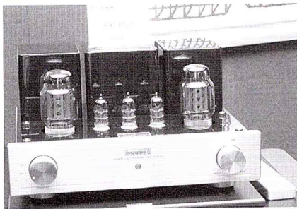
〔写真13〕 東京インターナショナルオーディオショウ2016に参考出品されたKT88 A級シングル10W + 10WパワーアンプTRX-P88S (2017年発売, 税別価格16万円)。左が電源スイッチで, 右がバイアス可能なボリュームコントロール
