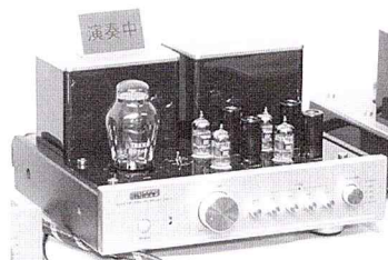
【写真2】TRX-1の後継となる真空管と半導体のハイブリッド型MC/MM対応プリアンプTRX-2。2013年真空管オーディオ・フェアに出品された（2013年発売、発売時税別価格30万円）
