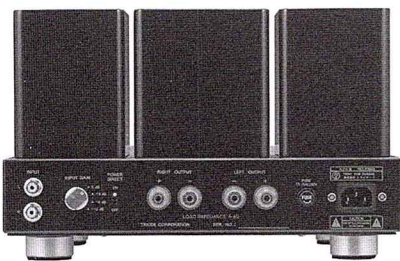
[写真8] TRX-P300Sのリアパネル。左から順に入力端子/ゲインセレクター/パワーダイレクトスイッチ/スピーカー端子
