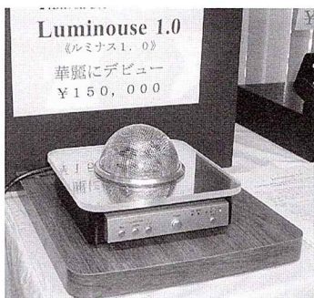
[写真1] 2000年、真空管オーディオ・フェアに出展されたD/Aコンバーター Luminous 1.0 (発売時価格15万円)。HDCD対応で、3色RGBイルミネーション/真空管出力/MOS-FET出力を装備
