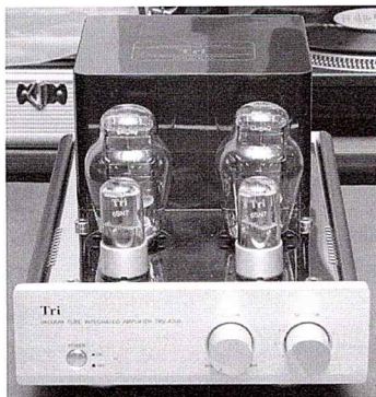
【写真4】 トライオード初の自己バイアス式300Bを採用したA級シングル8W+8WプリメインアンプTRV-A300(2003年発売、発売時税別価格15万円)
