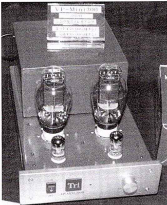
【写真3】 1998年真空管オーディオ・フェアに出品された8W + 8WのVP-Miniシリーズ300BシングルアンプVP-Mini300（発売時価格88,000円/キットは78,000円）
