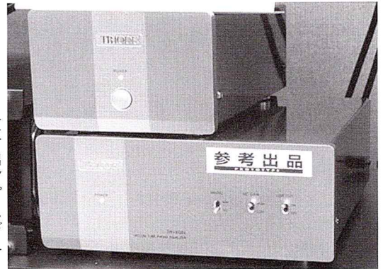
[写真15] 2019東京インターナショナルオーディオショウに参考出品された真空管MC/MMイコライザーアンプTRV-EQ8Xの試作機。下がアンプ本体で上が本体と分離した電源ユニット
