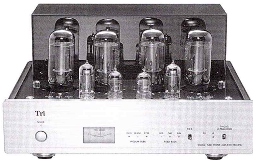
[写真14] 3種類の出力管を差し替え可能なAB級プッシュプルパワーアンプTRX-P6L(2010年発売, 発売時税別価格19万円)。6L6GC使用時の出力はUL接続で25W+25W, 3極管接続では12W+12W
