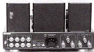
【写真6】 TRV-35SERの背面。EL34 AB級プッシュプル35W + 35WアンプでRCA端子は左から順にPHONO/LINE1/LINE2/REC OUT, LINE3は前面
