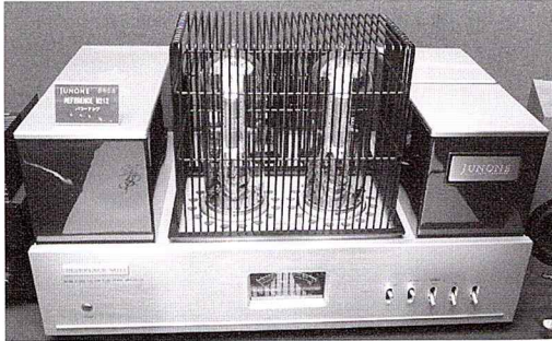
[写真11] 東京インターナショナルオーディオショウ2014に参考出品されたJUNONEブランドの大型3極管212採用A級パラシングル100WモノラルパワーアンプREFERENCE M212試作機
