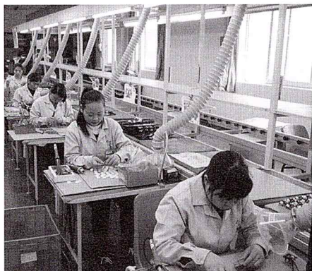
【写真3】 中国の協力工場におけるアンプ製造風景。各作業台にハンダ付けの吸煙ダクトを設けたクリーンな環境で製造されている
