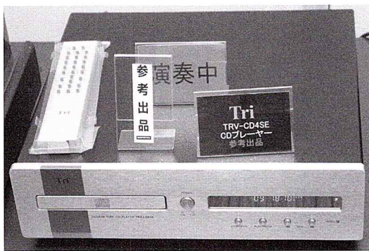
[写真15] 第4世代CDプレーヤー TRV-CD4SE。出力バッファに真空管を投入し、RCA出力とXLR出力を装備。(2007年発売、発売時税別価格12万円)
