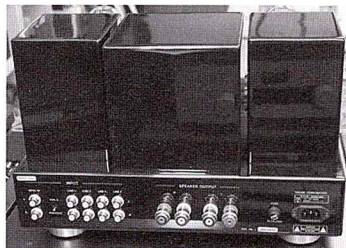
〔写真13〕 JUNONE845Sのリアパネル。左から順にMAIN IN/モードスイッチ/LINE1～4入力/スピーカー端子
