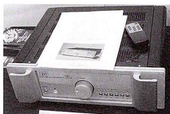
【写真4】 1999年真空管オーディオ・フェアに出品された純A級40W+40W/8Ωの無帰還出力段MOS-FETプリメインアンプTR-1 (発売時価格280,000円)
