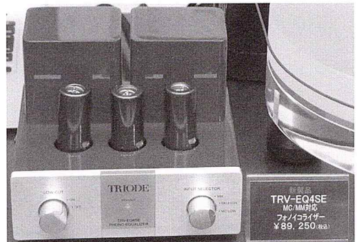
【写真2】ハイエンドショウトウキョウ2011秋に出品されたMC/MM対応フォノイコライザーアンプTRV-EQ4SE(発売時税別価格85,000円)。MC入力にトランスではなく、ヘッドアンプを採用
